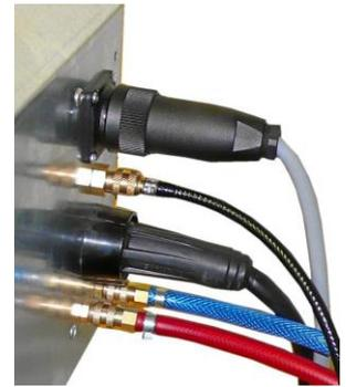
**WICHTIG BEI PULSANLAGEN MIT VORSCHUBKOFFER:** Das Zwischenpaket immer so gestreckt wie möglich auslegen. Durch Aufrollen des Pakets wird eine Induktivität im Schweißkreis erzeugt, welche der Pulserzeugung der Maschine entgegen wirkt. Es kann dabei zu schlechteren Schweißergebnissen kommen. Besonders wichtig bei langem Zwischenpaket (10m oder mehr). **NIEMALS** das Zwischenpaket um die Stahlflasche oder sonstige Eisenstrukturen wickeln!
